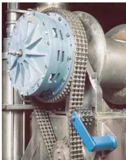
Kettingspanner aan mijnboorapparaat
